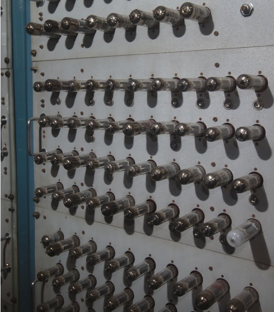
Esko-tietokoneen putkia. Vasemmalla sivulla ohjauspaneeli.
